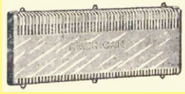
1895电车轨道加热器，由镍银丝制成，在瓷制的绝缘配件之间伸展 (在1895年，由J. Houston和A. E. Kennelly, 从“电加热”中引申出来)。
